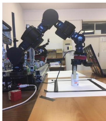
Fig. 5.8 Testarea în condiții de laborator a manipulatorului robotic cu 7DOF utilizând cutii ce au capacele divers colorate.
