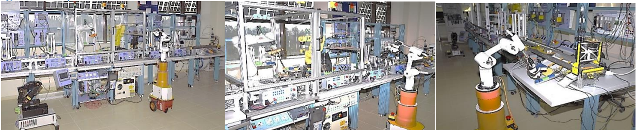
Figura 6. Linia de fabricație flexibilă de precizie, de laborator, asistată în procesul reversibil de dezasamblare de SAC-VAM (2DW/1FW), robot mobil echipat cu Manipulator 6-DOF, cu conducere integrată în tehnologii de asistare
